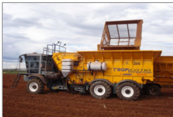
Foto 14 - Plantadora automotriz de cana picada Fonte: Usina no município de Dourados (2008).
