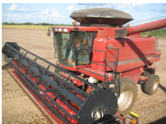
Maquinário utilizado no cultivo de grãos: (A) Colhedeira de grande porte com plataforma de soja; (B) Colhedeira colhendo a soja.
