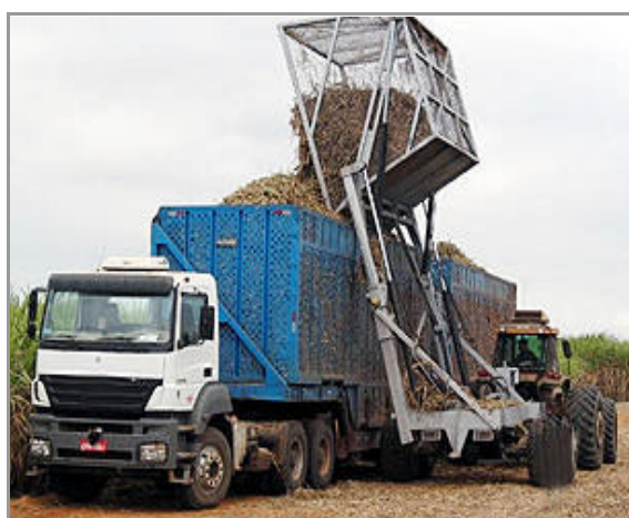
Foto 16 - Caminhão reboque com transbordo (utilizado no carregamento de cana-de-açúcar) Fonte: www.sacaroseonline.com.br (2010)
