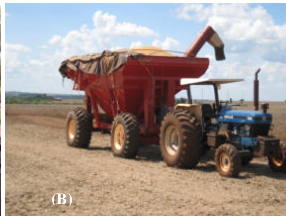
Maquinário utilizado no cultivo de grãos: (A) Plantadeira engatada em trator; (B) Carretão engatado no trator (este implemento é utilizado para carregamento e descarregamento de grãos na ausência de caminhões ou como auxiliar nas colheitas. Os mesmos são utilizados na cultura do milho.
