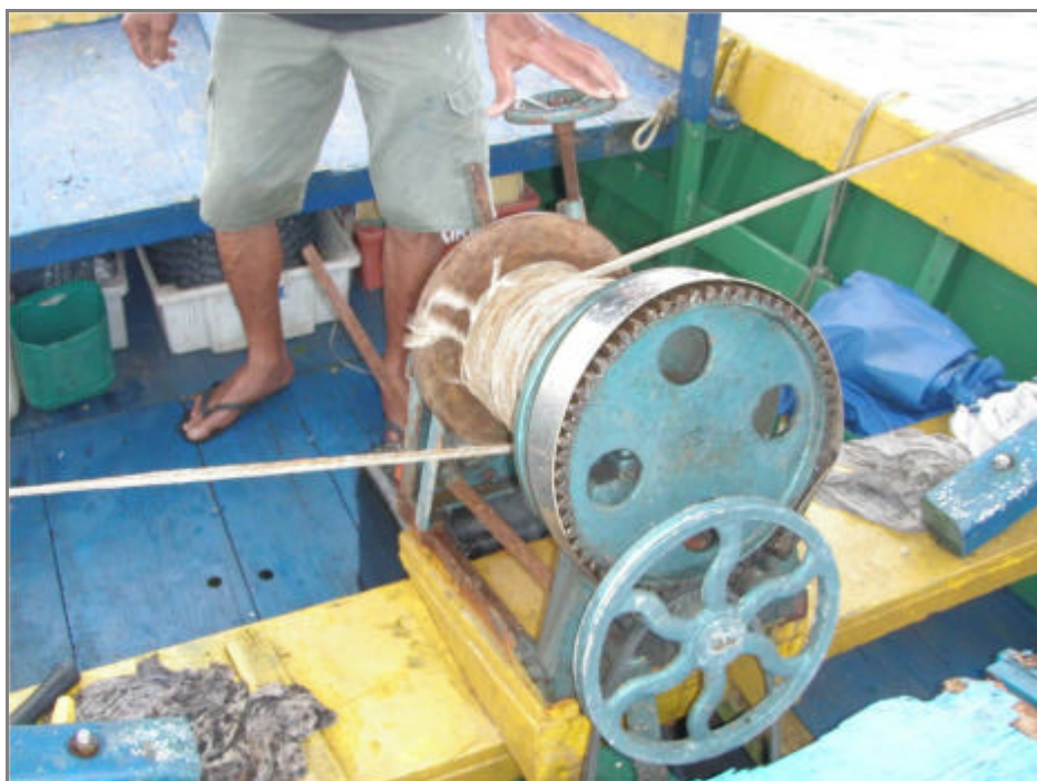
Guincho mecânico - utilizado para recolhimento das redes
