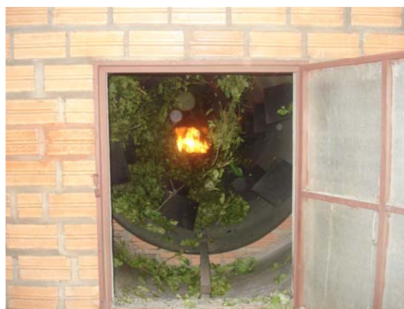
FOTO 17 - Sapecador mecânico sediado na ervateira “Erva-Mate São Roque” de Amambai Fonte: Cláudia Barbosa do Carmo (Dez/2006)
