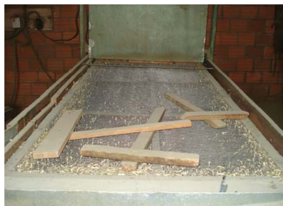
FOTO 25 - Peneira utilizada para separação granulométrica em indústria sediada no município de Tacuru Fonte: Cláudia Barbosa do Carmo (Dez/2006)
