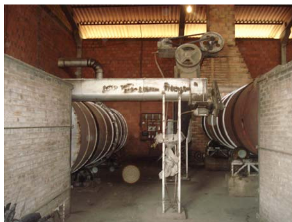
FOTO 19 - Sapecador e secador mecânico em indústria sediada no município de Tacuru Fonte: Cláudia Barbosa do Carmo (Dez/2006)
