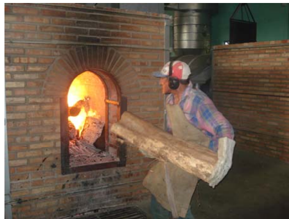
FOTO 15 - Trabalhador alimentando fornalha do sapecador mecânico na mesma indústria Fonte: Cláudia Barbosa do Carmo (Dez/2006)
