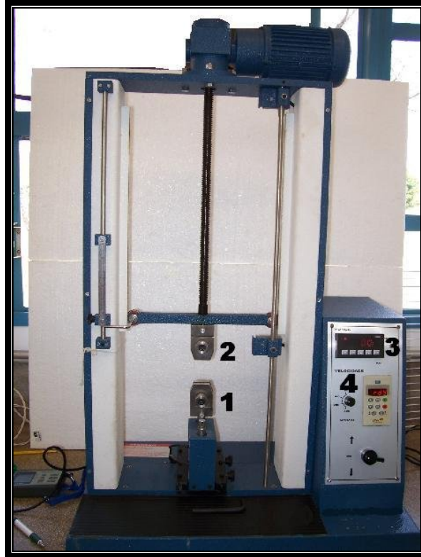
Figura 5: Equipamento de ensaio universal (dinamômetro) composto de célula de carga (1), dispositivo do ensaio de tração e/ou rasgamento contínuo (2), indicador digital (3) e seletor de velocidade de afastamento da barra (4).
