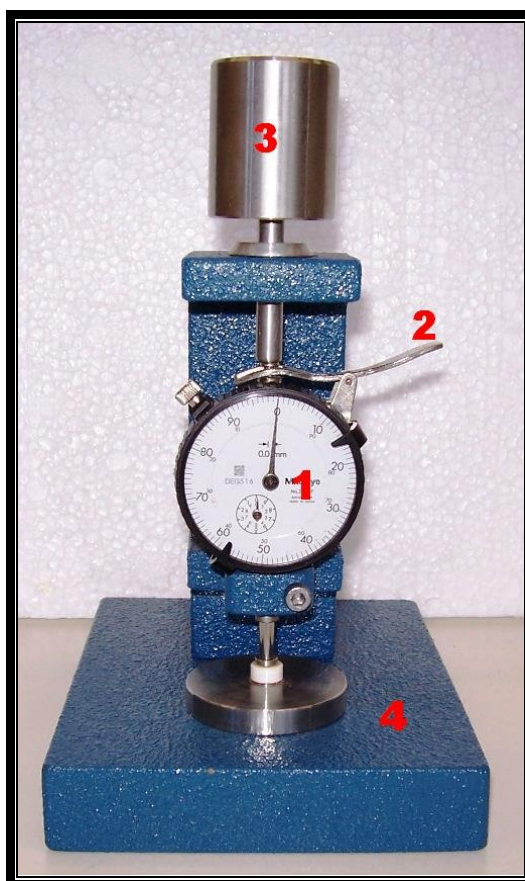
Figura 4: Espessímetro Mitutoyo utilizado para determinar a medida da espessura do couro, composto de relógio comparador (1), haste de movimentação da massa de pressão (2), massa de pressão (3) e base de apoio do couro (4).
