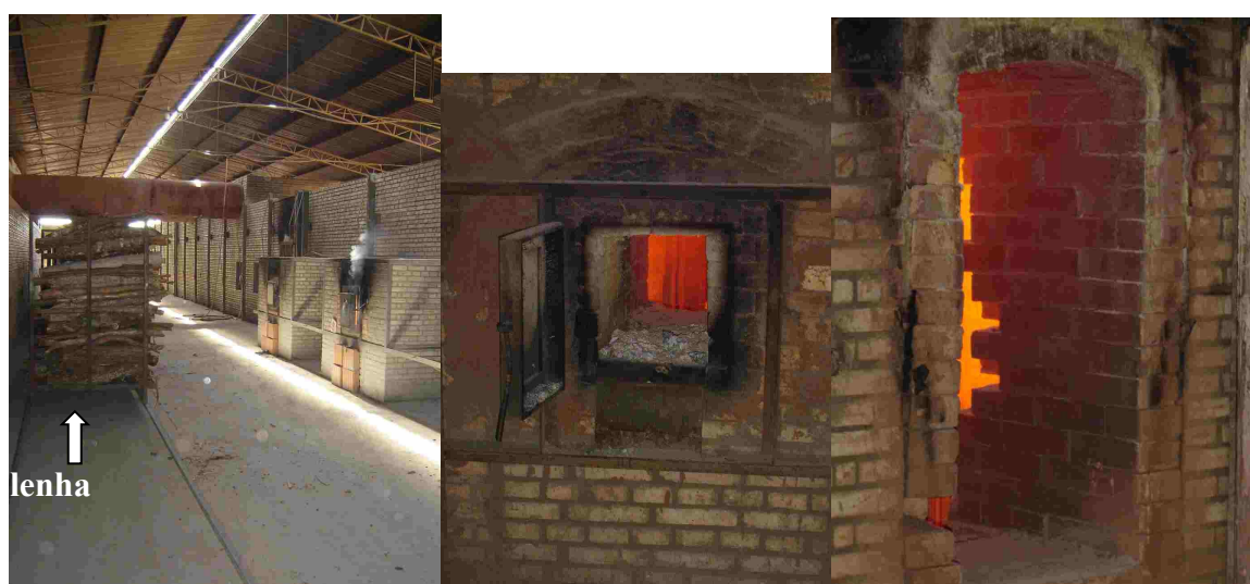
FOTO 16 - QUEIMA DE TIJOLOS EM FORNO CONTÍNUO COM USO DE LENHA
