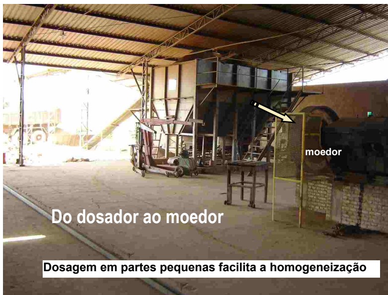
Foto 08 - MOAGEM DA ARGILA PARA HOMOGENEIZAÇÃO DA MASSA
