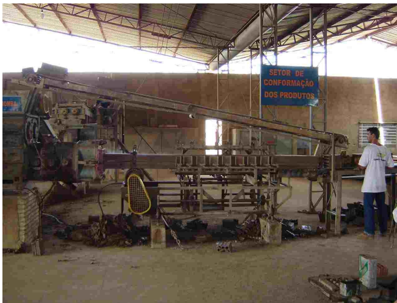
FOTO 11 - MOLDAGEM DA PASTA EXTRUSADA
