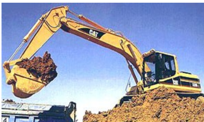
FOTO 06 - EXTRAÇÃO DE ARGILA COM RETRO-ESCAVADEIRA
