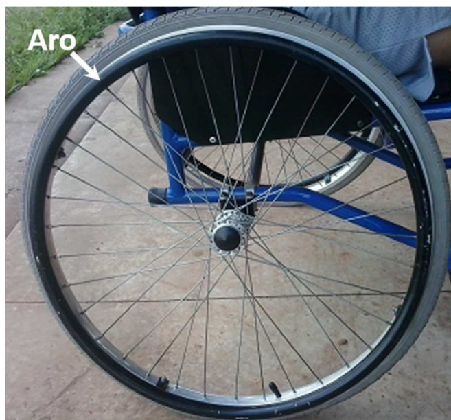
Figura 2. Aro de propulsão ou de impulsão. Onde o atleta faz a pegada para gerar torque. Nada tem de diferente das demais cadeiras de rodas. Fotos realizadas na Universidade Católica Dom Bosco.
