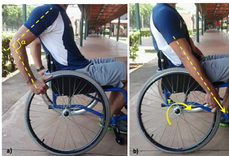
Figuras 4 Observação do ângulo do braço ( \alpha ) e pegada da mão no aro de propulsão para gerar um torque mais eficiente na roda. Fotos realizadas na Universidade Católica Dom Bosco.
