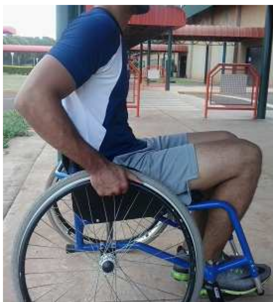
Figura 3. Local da pegada da mão no aro da roda da cadeira para geração de torque. Fotos realizadas na Universidade Católica Dom Bosco.
