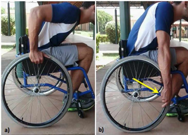
Figura 5. A seta indica a direção em que o torque deverá ser transferido da mão para a roda. Uma ilustração indicando a direção em que a força mecânica será mais eficaz, ou seja, a direção onde a força é efetivamente aplicada. Fotos realizadas na Universidade Católica Dom Bosco.
