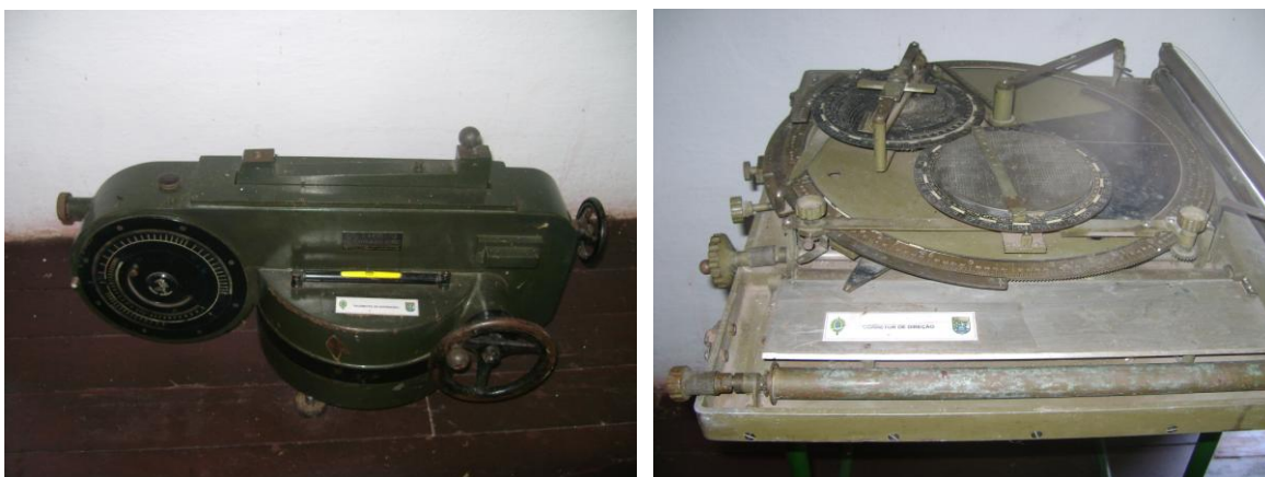
Figura 39 - Telêmetro de depressão e corretor de direção de tiro M-1
