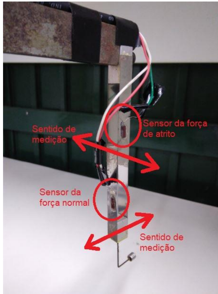
Figura 23. Sensores de medição de deformação substituídos.
