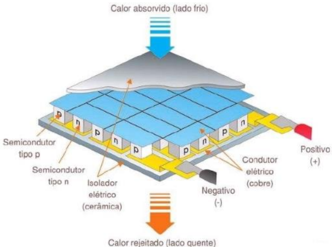
Figura 7. Princípio de funcionamento da pastilha termoeétrica.
