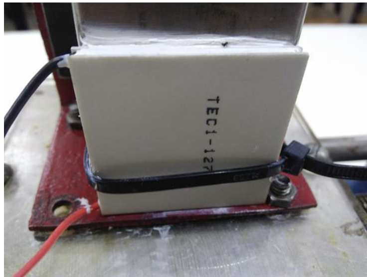
Figura 10. Fixação da pastilha termoelétrica de efeito Peltier no recipiente. Fonte: Próprio autor.
