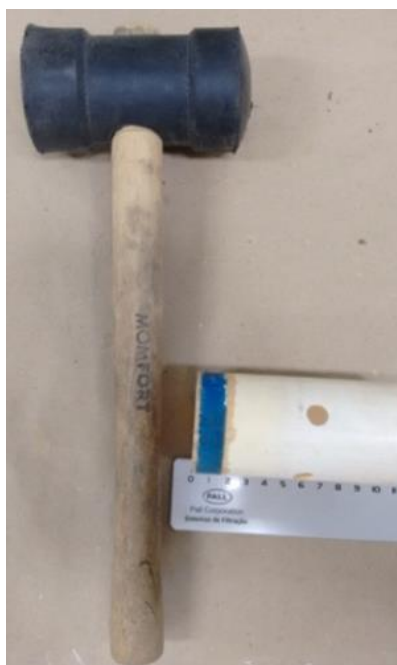
Figura 4: Instrumentos, martelo de borracha e cano PVC, utilizados para coletar as amostras de solo no Pantanal, em Mato Grosso do Sul.
