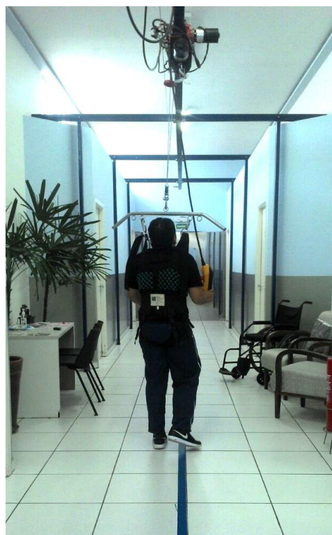
Figura 10 -Foto da montagem da estrutura dos trilhos de suspensão para marcha. Fonte: Próprio autor.
