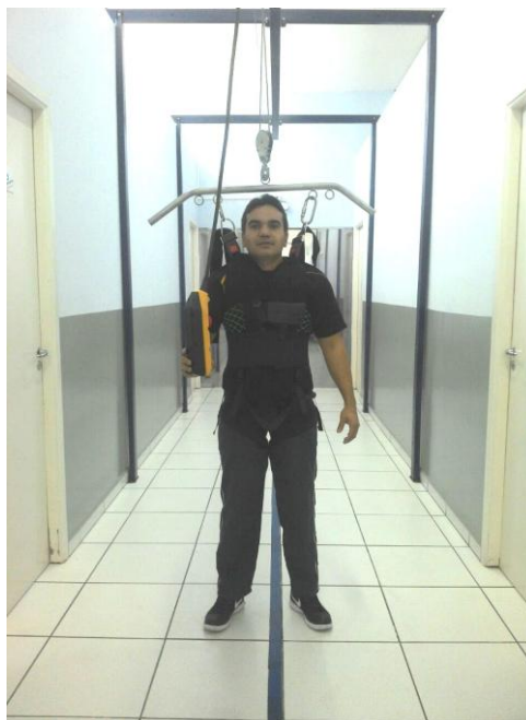
Figura 9 -Foto da montagem da estrutura dos trilhos de suspensão para marcha. Fonte: Próprio autor.
