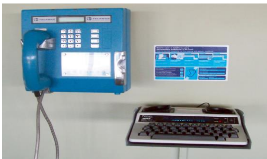
Figura 6: TDD – Telephone Device for Deaf ou telefone para surdos
