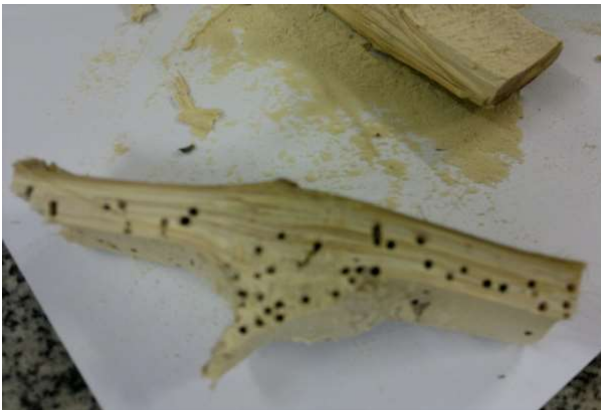
Figura B3 – Perfurações realizadas pelo caruncho Dinoderus minutus em toletes de bambu e pó produzido pós-ataque.
