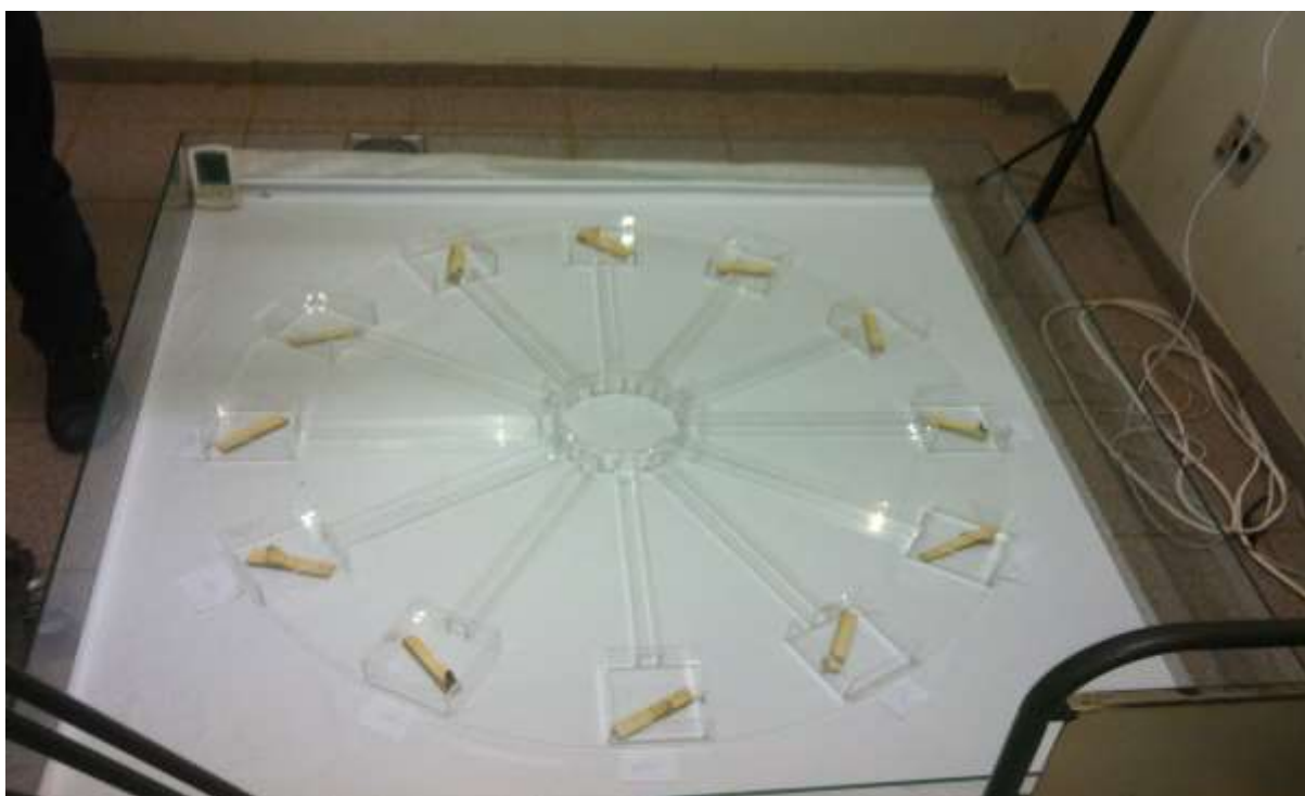
Figura C5 – Arena de acrílico apoiada sobre um tecido branco no solo para facilitar a captura de imagens do caruncho do bambu pela câmera filmadora Sony DCR-SR300.
