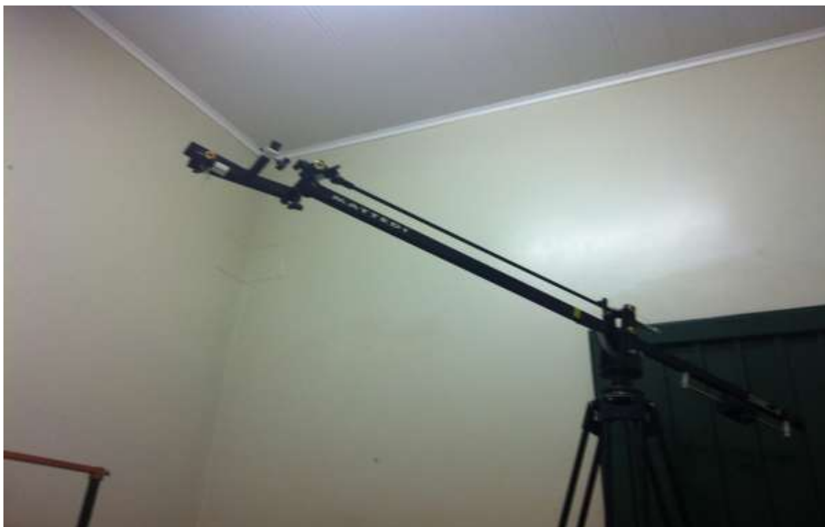
Figura C4 - Suporte com haste de sustentação da câmera filmadora Sony DCR-SR300 para captura de imagens do deslocamento do caruncho do bambu em direção aos toletes de Bambusa vulgaris , posicionado a 2,5 m acima da arena de acrílico.
