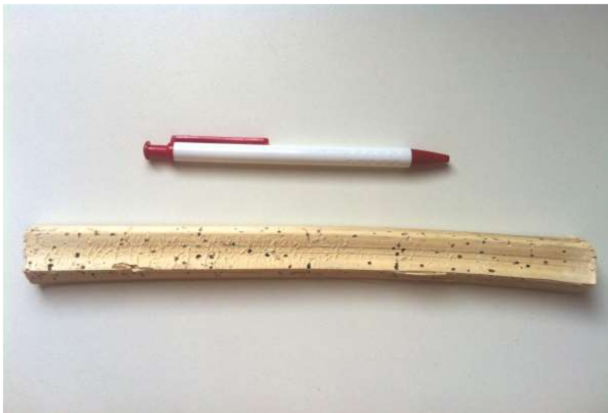
Figura B2 – Perfurações realizadas pelo caruncho Dinoderus minutus em toletes de bambu.
