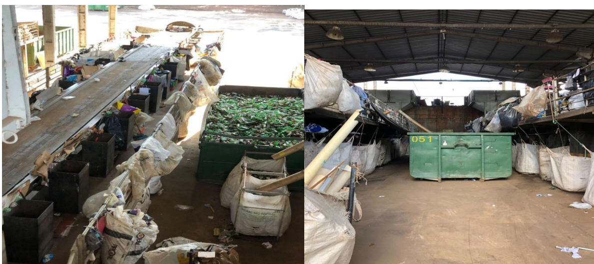
Figura 31 - Acondicionamento de rejeitos segregados em big bags na Central de Triagem da Solurb
