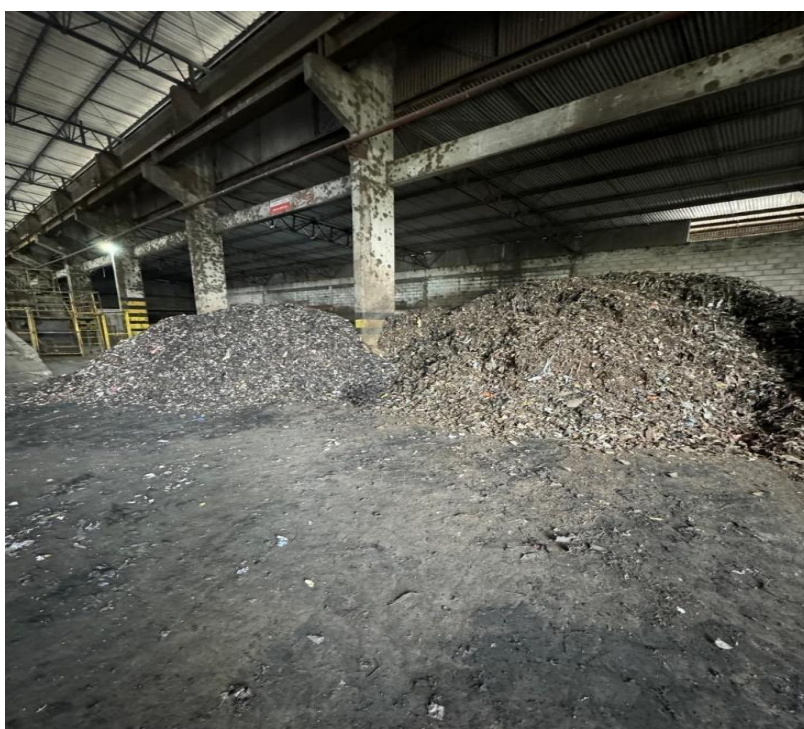
Figura 36 – Armazenamento do blend de resíduos triturados na unidade da InterCement. Bodoquena/MS
