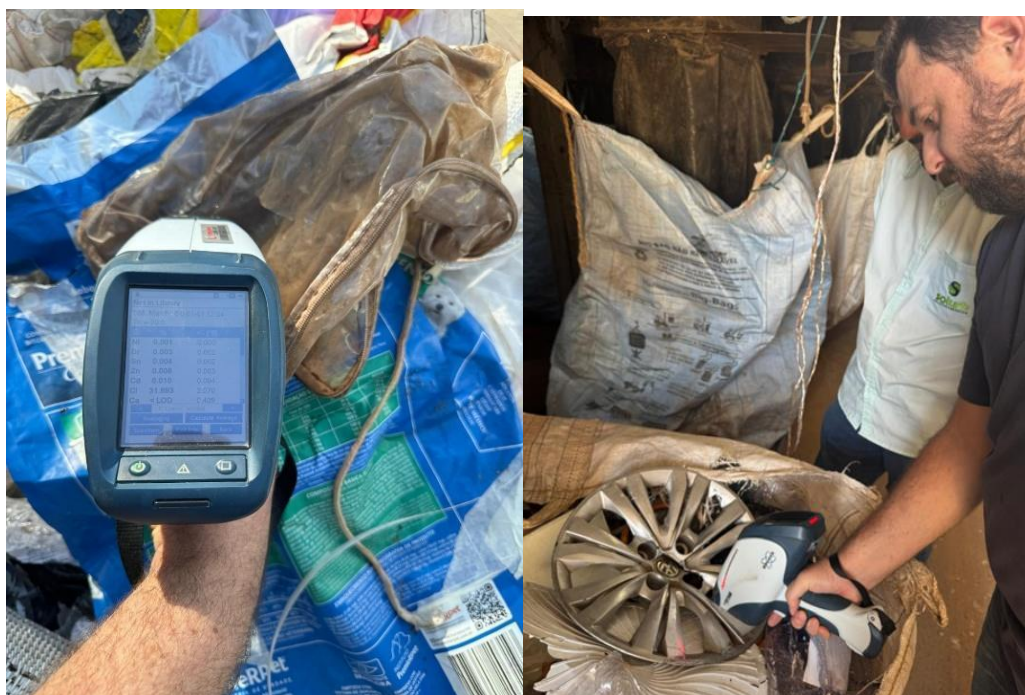
Figura 34- Avaliação da composição química de embalagens plásticas com espectrômetro portátil (XRF) durante triagem dos rejeitos.
