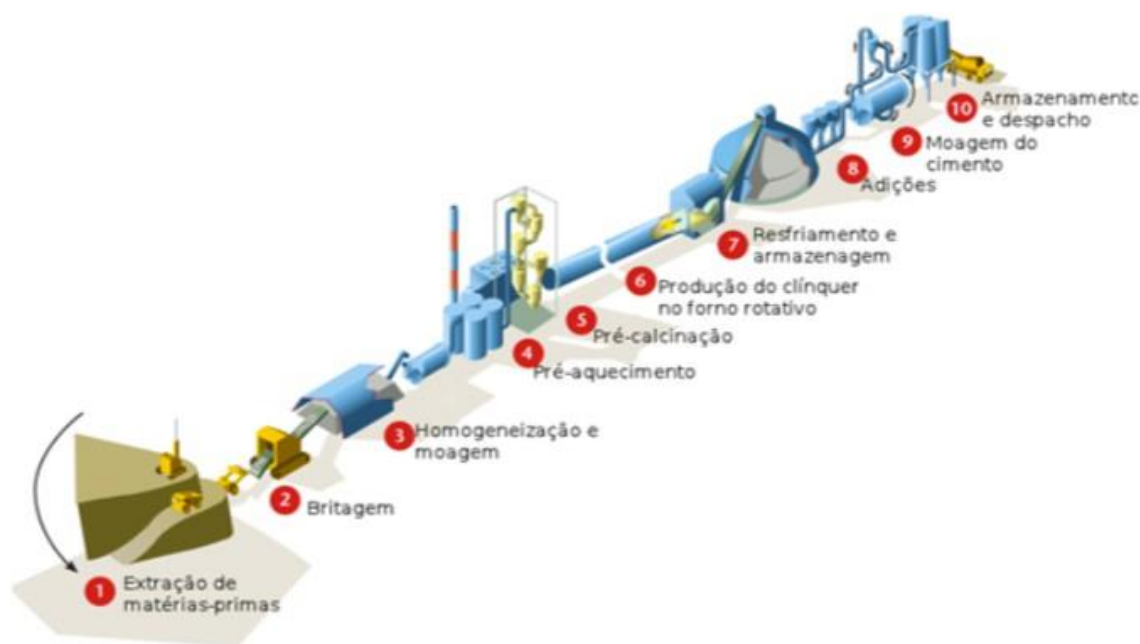
Figura 23 - Esquema do processo de fabricação do cimento Portland
