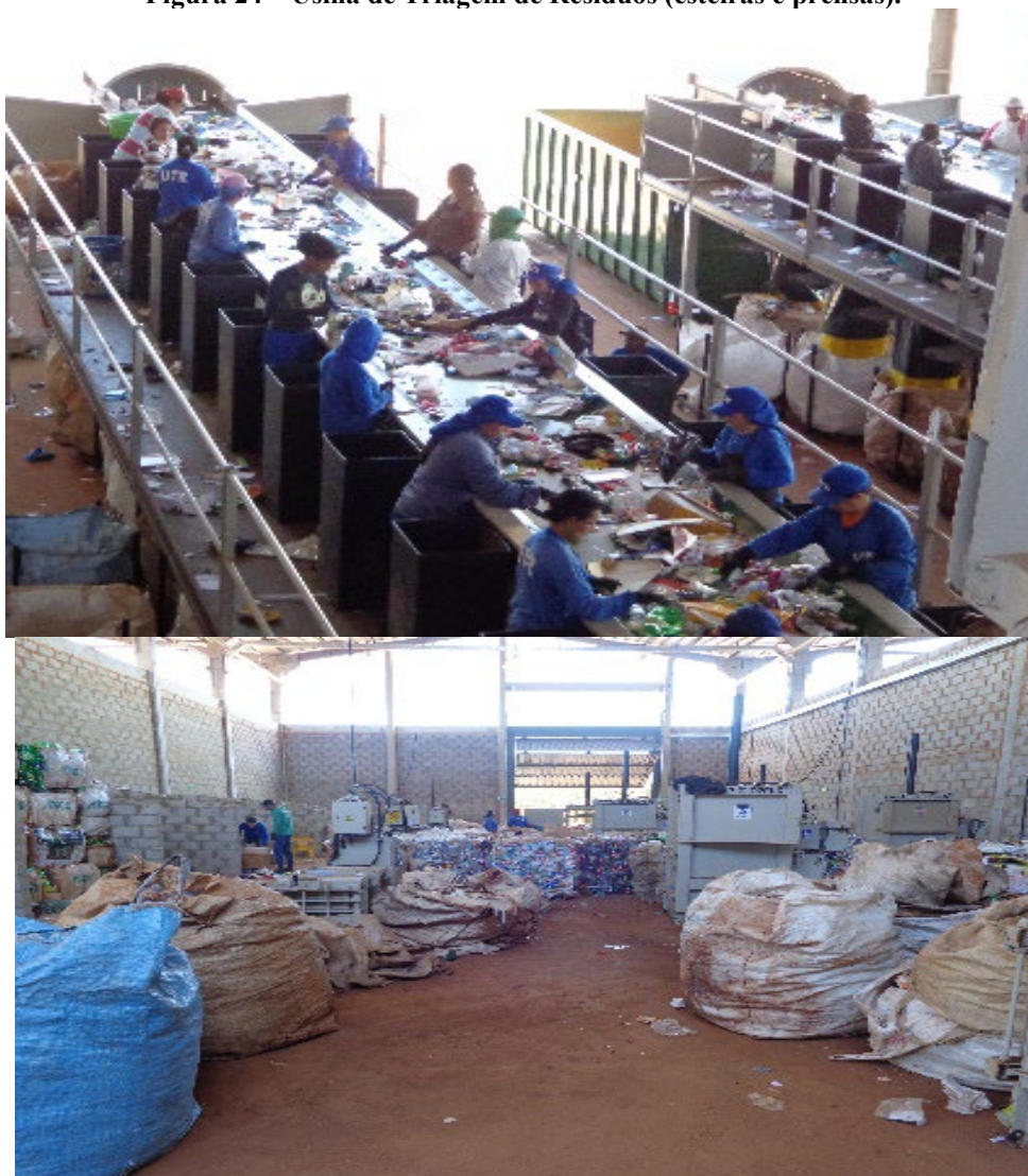
Figura 24 – Usina de Triagem de Resíduos (esteiras e prensas).
