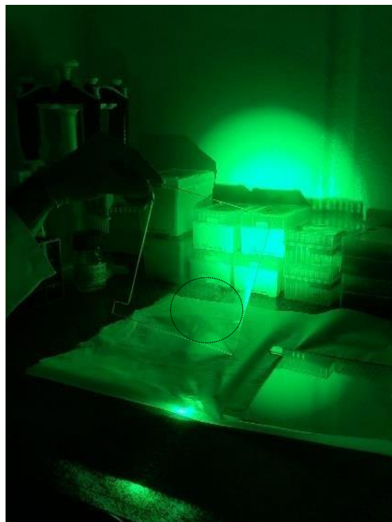
Figura 5: Ilustra o uso da luz UV para localizar impressões latentes no plástico. O círculo indica as marcas visíveis após a aplicação do espectro luminoso.
