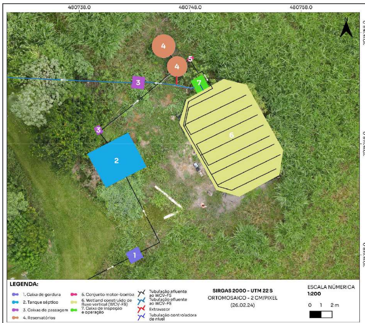
Figura 13 – Configuração do sistema de tratamento localizado no CETREVI.
