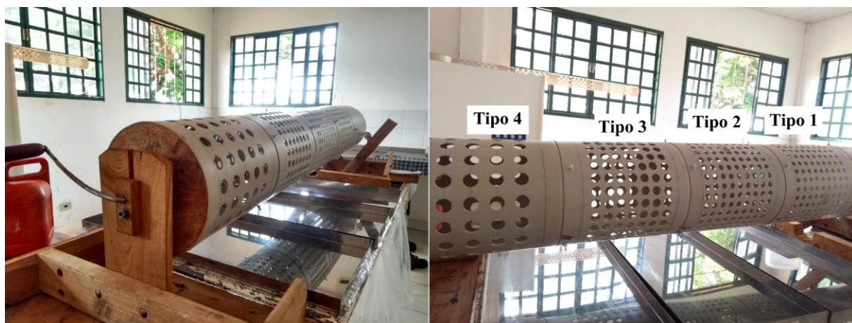
Figura 3- Classificador de frutos manual horizontal, Campo Grande-MS, Patente de número BR 20 2022 014162 8, 2021.
