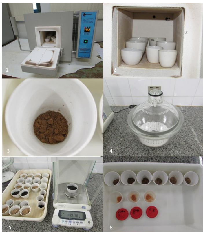
Figura 5A: Etapas para determinação da porcentagem de cinza.
