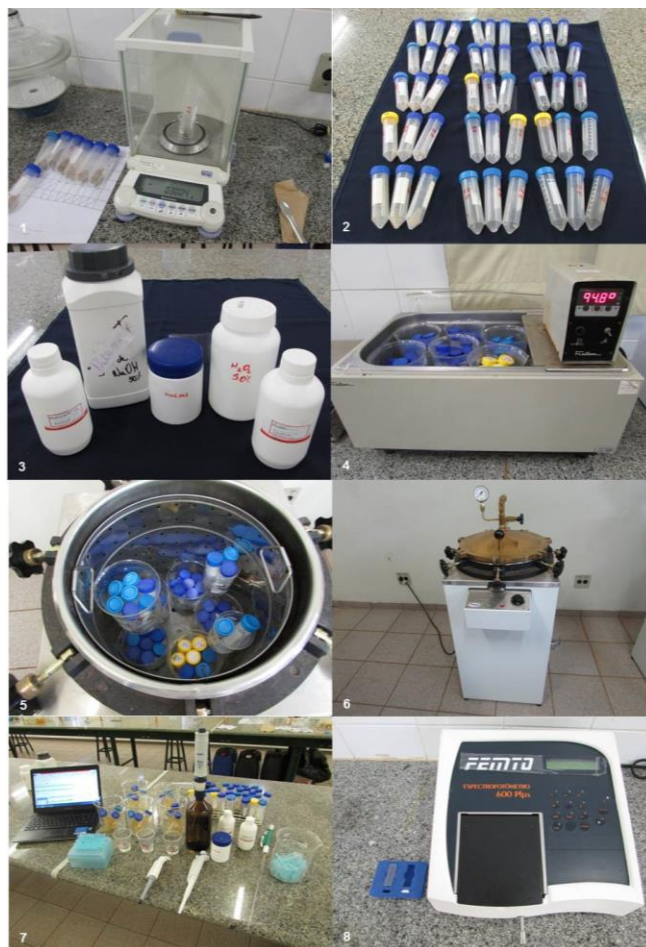
Figura 6A: Etapas para determinação da porcentagem de silício
