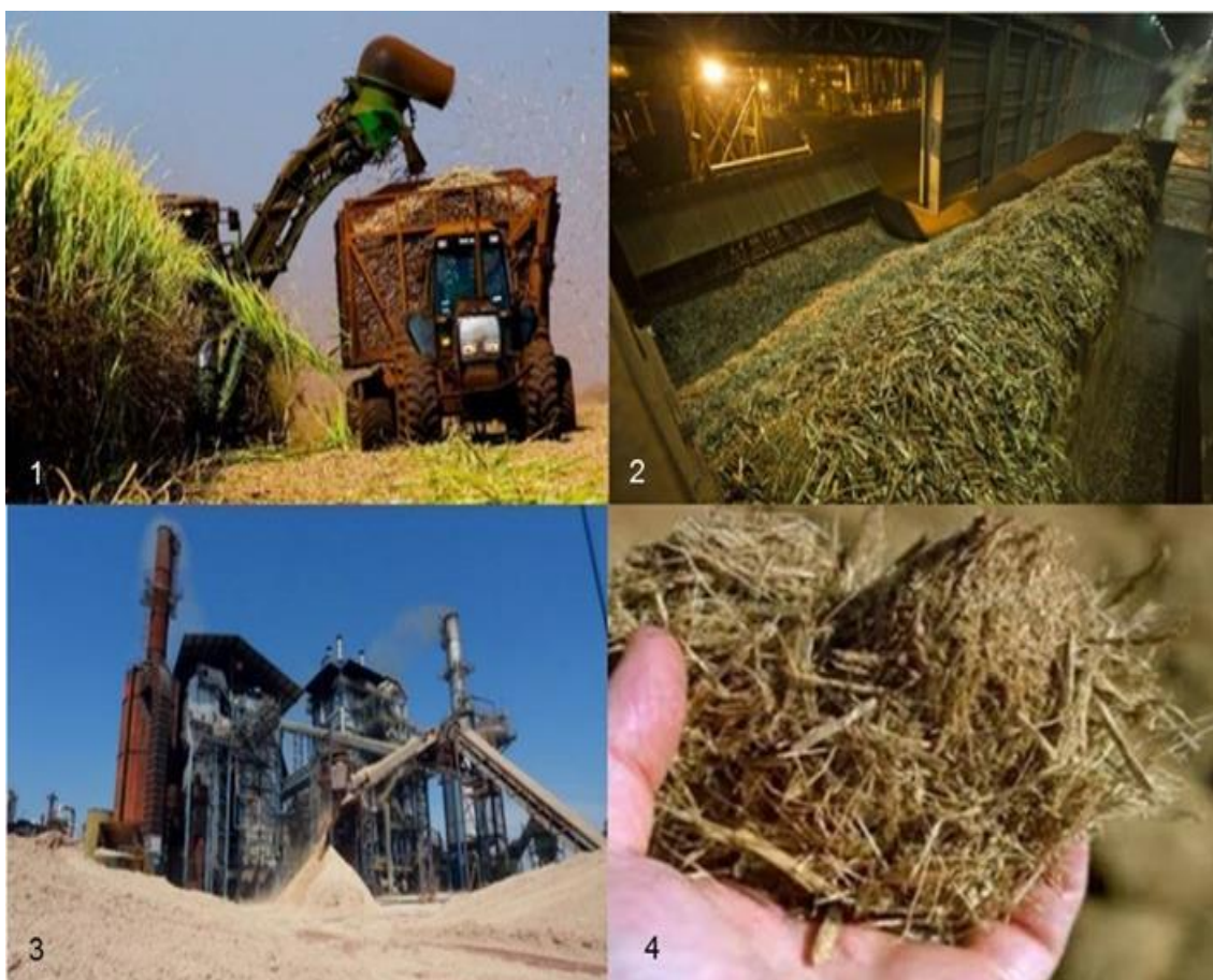
Legenda: (1) Colheita mecanizada da cana-de-açúcar; (2) Alimentação da moagem; (3) Armazenagem junto a caldeira; (4) Fibras do bagaço
