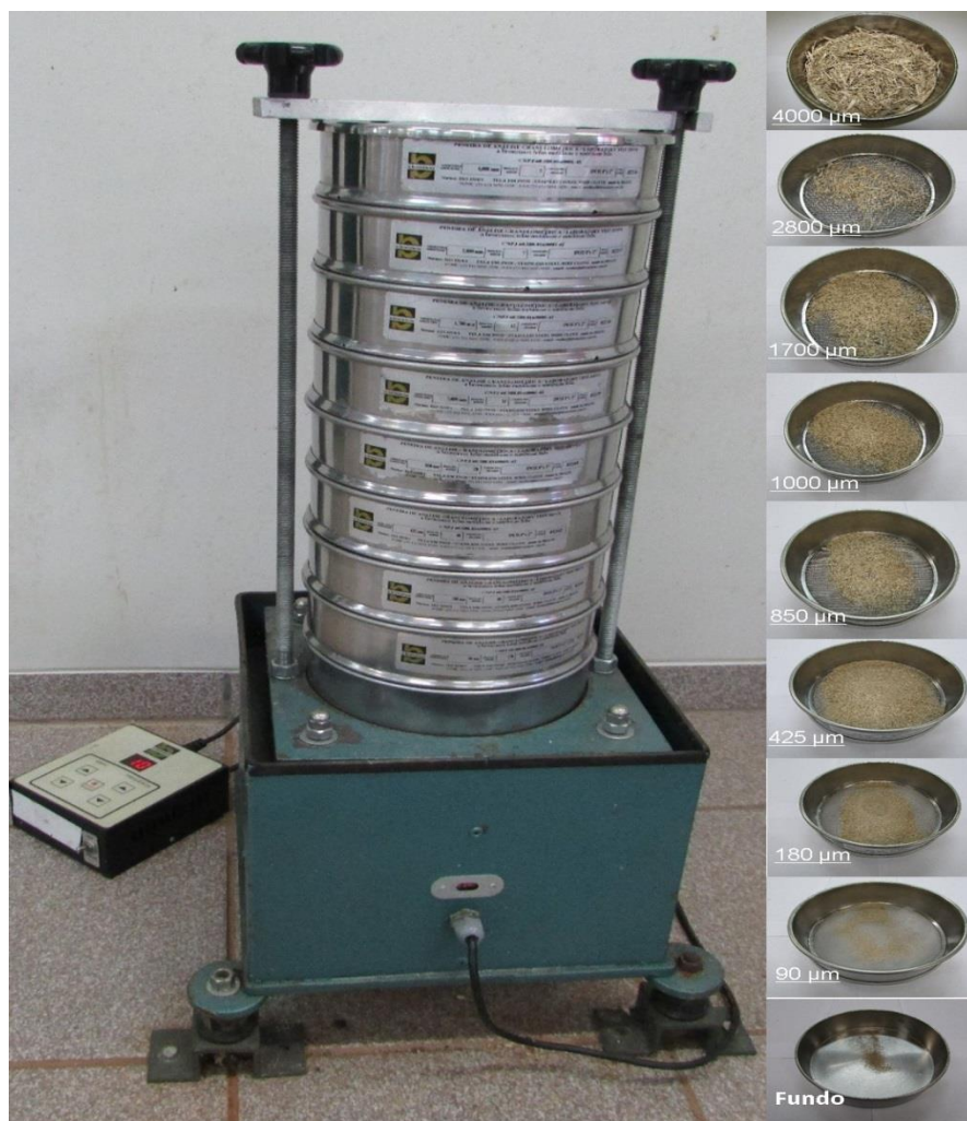
Figura 3A: Equipamento de vibração e peneira para determinar a granulometria
