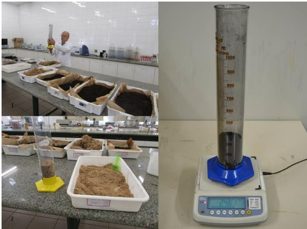
Figura 2A: Etapas para determinação da densidade das amostras.
