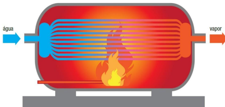
Figura 14: Esquema de funcionamento de uma caldeira aquatubular Fonte: ELEKTRO, (2015).
