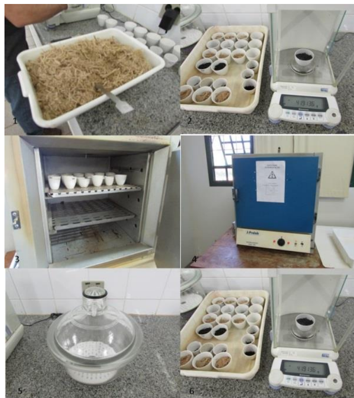
Figura 4A: Etapas para determinação da porcentagem da umidade
