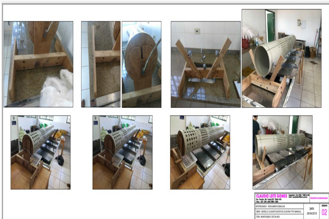
Figura 4: “Classificador de guavira tipo manual”, sob ART de Obra/Serviço 1320190037116, com registro no CREA/MS.
