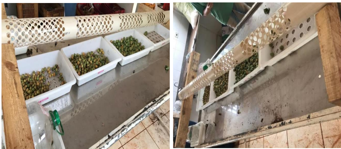
Figura 1: Protótipo do classificador manual de frutos sendo testado com frutos de guavira provenientes do campo experimental da Agraer em Campo Grande, MS, Outubro de 2018.
