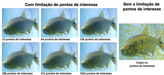
Figura 2. Seis imagens de peixes exibindo os pontos de interesse detectados com suas respectivas limitações e uma imagem exibindo todos os pontos de interesse detectados.
